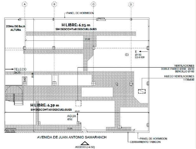
SOBRECARGA DE USO: 10 KN/m<sup>2</sup> (1.000 kg/m<sup>2</sup>)
